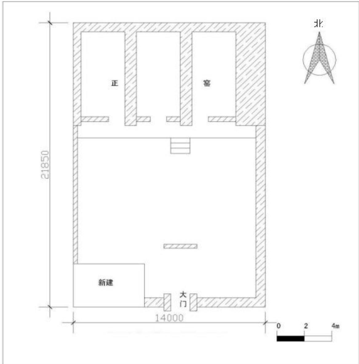
中央后委机关旧址—毛泽东同志路居平面示意图
